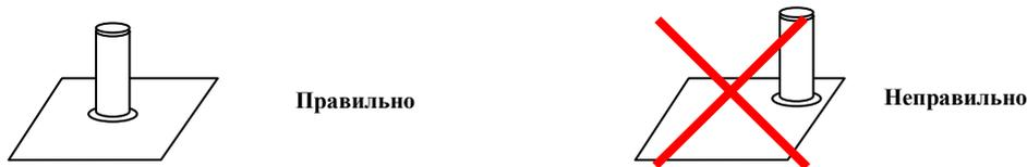
2. Антенна устанавливается так, чтобы перпендикуляр к оси антенны был направлен на базовую станцию GSM. Если точное направление на источник сигнала не известно, антенну следует устанавливать **вертикально**.
